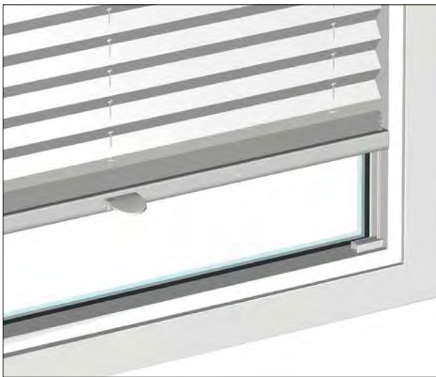
Montagemöglichkeit in die Glasleiste mit Spannschuhen.
